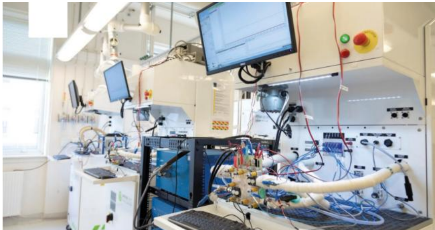
Figur V6. Testing og evaluering av ytelsen til PEM-brenselceller var en sentral forskningsaktivitet i MoZEES (Foto: Norsk brenselcelle- og hydrogensenter, SINTEF, Trondheim) Bilde: MoZEES sluttrapport
