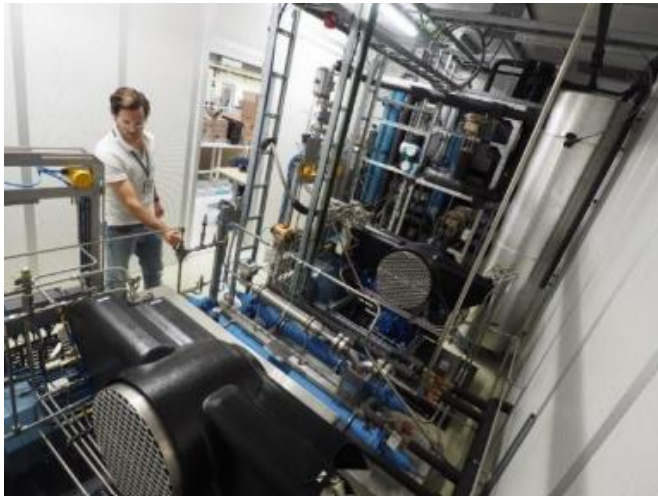
Figur V32. Labanlegg for separasjon og flytendegjøring av CO 2 . Foto: SINTEF
