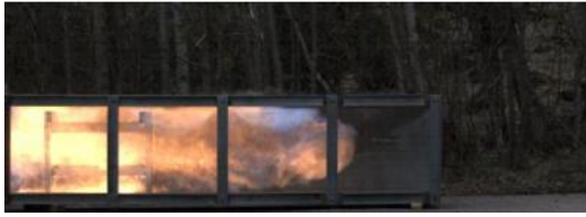
Figur V8. Testoppsett ved FFI med en 6 meter lang kanal. Bildet er fra en høyhastighetsfilm som viser deflagrasjon av en etan-hydrogen-blanding med en barriere/obstruksjon til stede. Bilde Fra effektstudien Foto: USN/FFI
