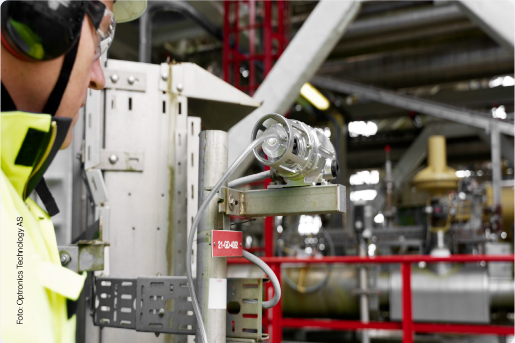
Pilottest av gassdetektor for overvåking og deteksjon av lekkasjer
