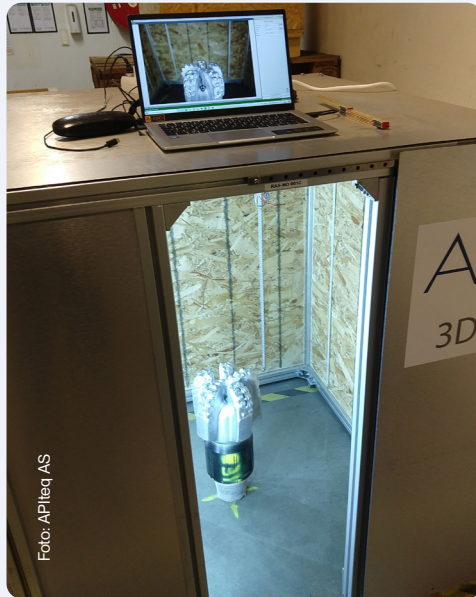
APIteq AS pilot-testing av 3DRILL borekrone-skanner
