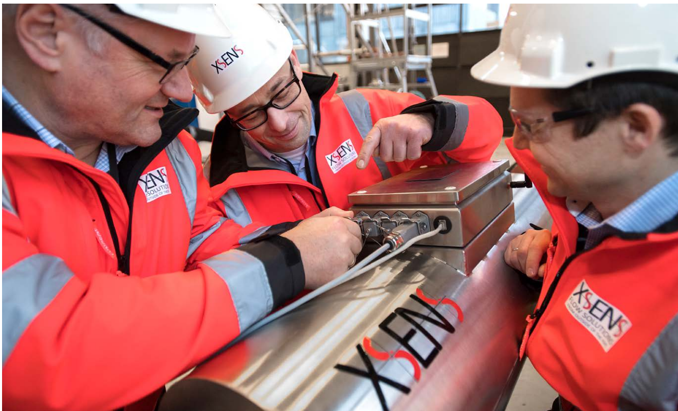
Xsens flow-meter for energi- og utslippsreduksjon. Xsens clamp-on flow-metertechnologi for sikker og nøyaktig prosessmåling i oljeindustrien, samt utslippsrapportering og drivstoffreduksjon på skip. Magne Husebø, Remi Kippersund, Kjell-Rune Toftevåg (alle Xsens AS).
