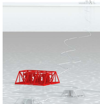
ABB Subsea substation – neste generasjon subsea elektriske kraftsystem.
