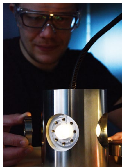
Trykketank med seglass for studie av overflatefenomen ved høye hydrostatiske trykk og elektriske spenninger.
