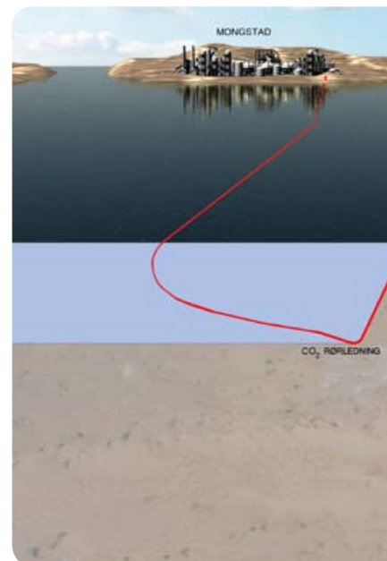
Transport av CO 2 fra fangst-anlegg på land til injeksjonslokalitet på sokkelen. Ill: Gassnova.
