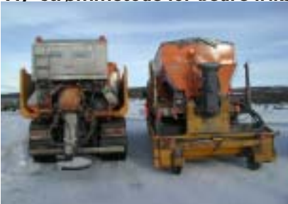
To typer utleggingsmaskiner for uttesting av det nye sandstrøingskonseptet. Bilen til venstre kan også benyttes for salting
