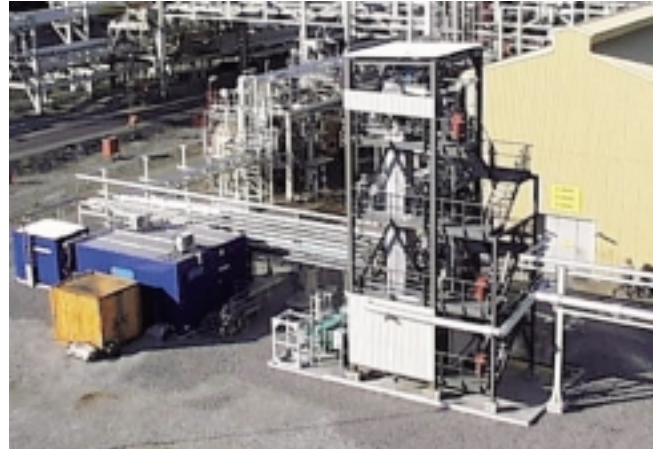
Pilottesting med en oppskalert katalysator gjennomføres på Mongstad-raffineriet.
