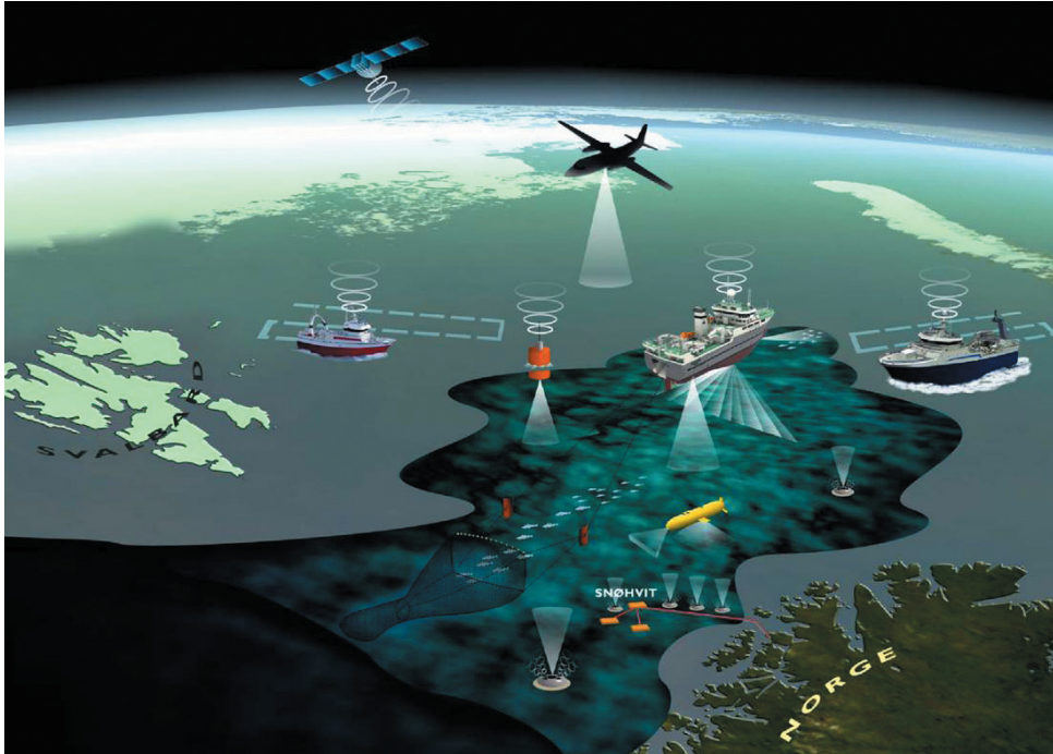
Et nettverk av akustiske sendere og mottakere kan bidra til å overvåke miljøet og fiskebestandene i Nordsjøen i framtida. Ill. Kongsberg Maritime
