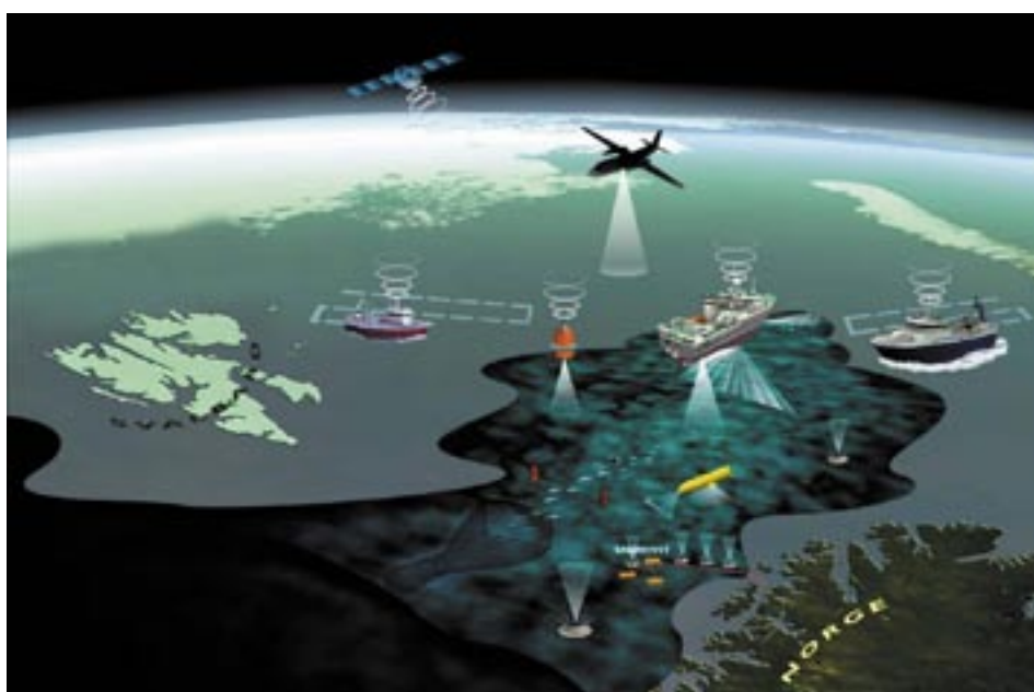
MILJØPROSJEKT: Spesielt i de nordlige områdene av Nordsjøen og Barentshavet kan det være et stort behov for å etablere et nettverk av noder og sensorer for å overvåke miljøet. III: KM
